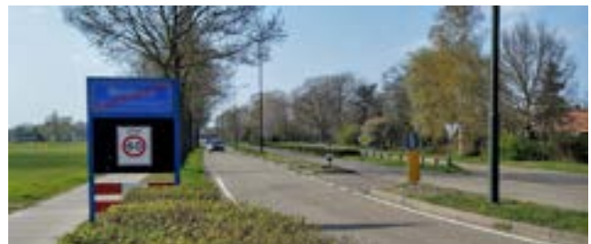
Image 9: Zone 60 on a road with separate lanes and separate bicycle paths does not conform to CROW. (See CROW publication Basisinformatie\Basiskennmerken wegontwerp - Categorisering en inrichting van wegen, paragraaf 1.1.6 Veilige snelheden en geloofwaardige snelheidslimieten).
